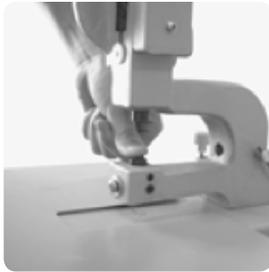
9. Setzen Sie nun den Unterstempel aus dem Umrüstsatz ein und stellen Sie diesen mit der Stellschraube möglichst weit nach unten.
