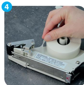
Führen Sie die Rolle unter der transparenten Rollenfixierung durch.
