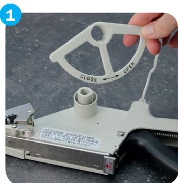
Drehen Sie die Rollenabdeckung entgegen des Uhrzeigersinns und entfernen Sie diese anschließend.
