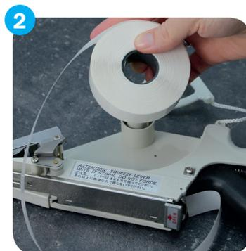
Platzieren Sie die Rolle und setzen Sie die Abdeckung wieder an Ihre ursprüngliche Position.
