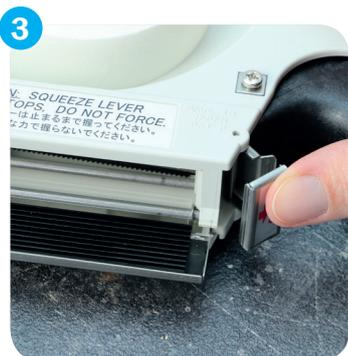
Entriegeln Sie die untere Abdeckung indem Sie die Verriegelung zurückschieben, welche mit „Open“ gekennzeichnet ist.
